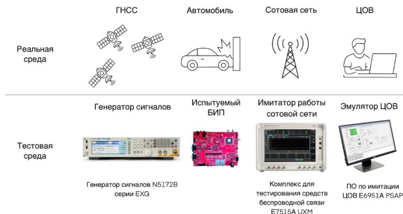
Рисунок 2. Архитектура испытательного стенда на основе UXM E7515A
