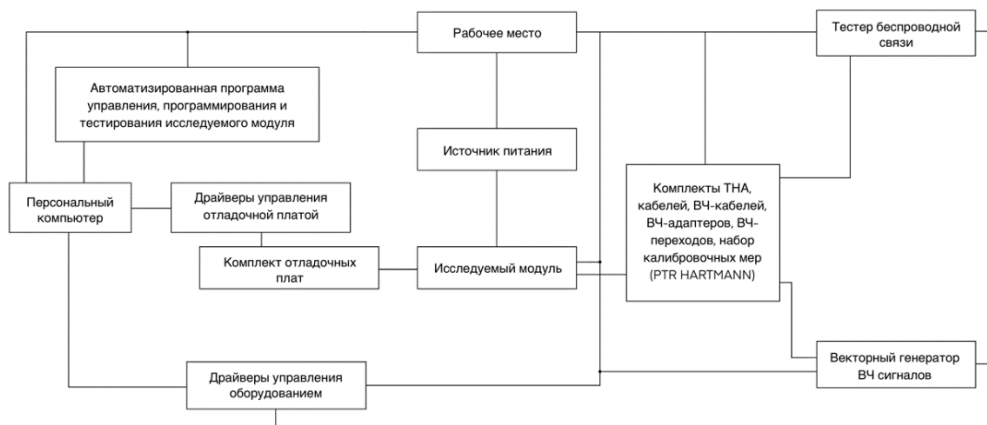
Рисунок 1. Функциональная схема проведения сигнального тестирования оконечных устройств
