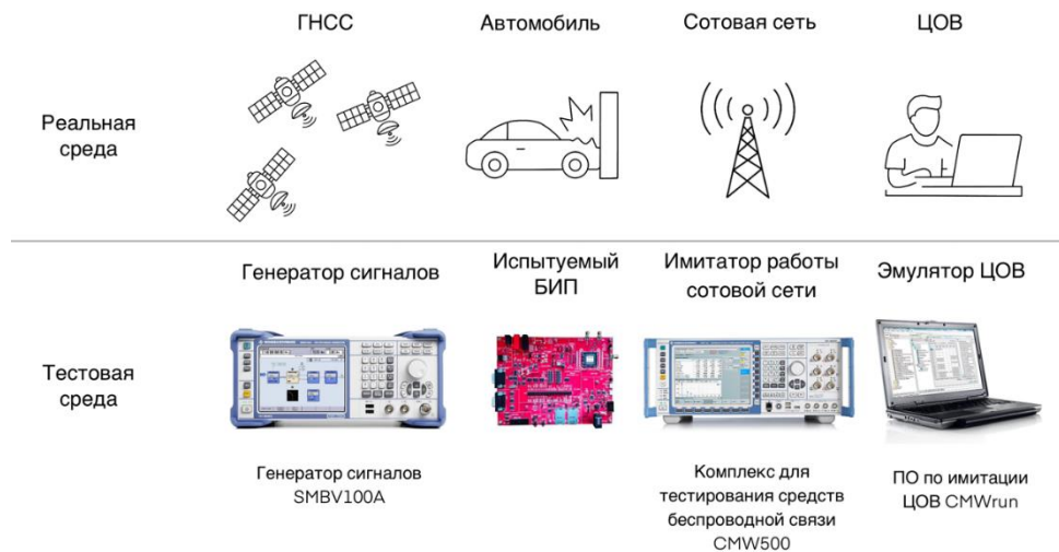
Рисунок 4. Архитектура испытательного стенда на основе CMW500
