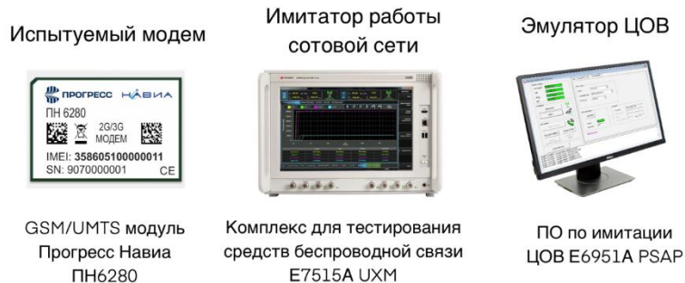
Рисунок 1. Архитектура проведения испытаний
