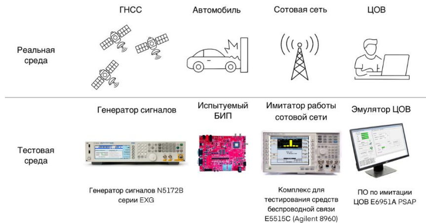
Рисунок 3. Архитектура испытательного стенда на основе Agilent E5515C (8960)
