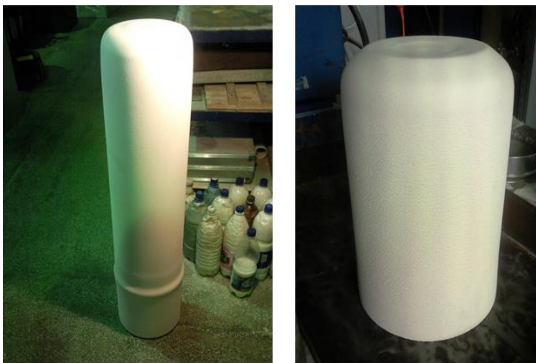
Рисунок 2. Модификации проницаемых дифрагм с канальной пористостью
