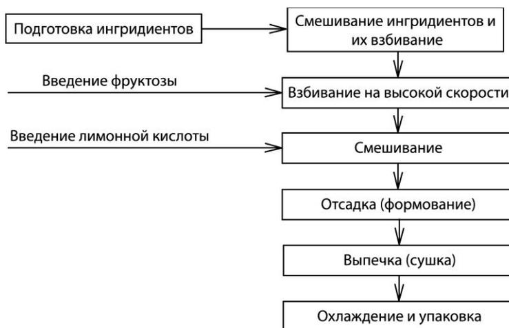
Рисунок 11. Технологическая схема производства безе обогащенного фруктозой
