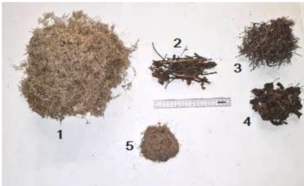
Рисунок 1. Пример результатов определения фракционного состава выборки верхового торфа: 1 – сфагнум, 2 – ветви сосны, 3 – иголки сосновые, 4 – кора сосны, 5 – разрушенные частицы торфа
