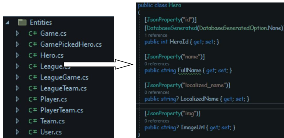
Рисунок 2. Набор классов и пример класса для преобразования в таблицы базы данных
