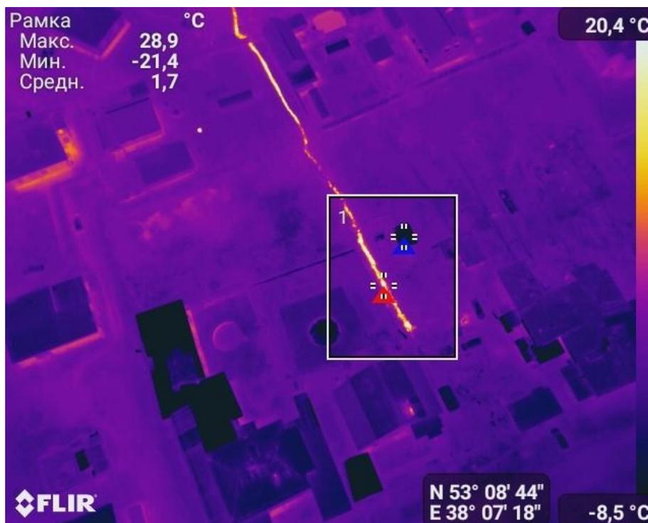
Рисунок 3. Процесс телевизионного обследования тепловых сетей с БПЛА
