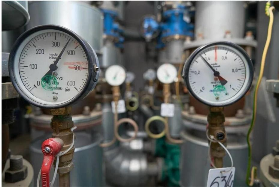
Рисунок 2. Процесс проведения гидравлических испытаний трубопроводов
