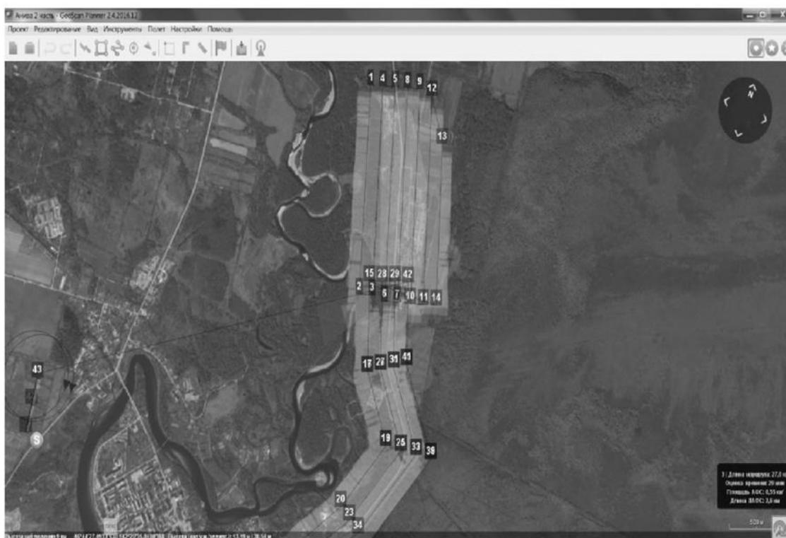
Рисунок 1. Использование АФС при построении маршрута в программе планирования полетного задания
