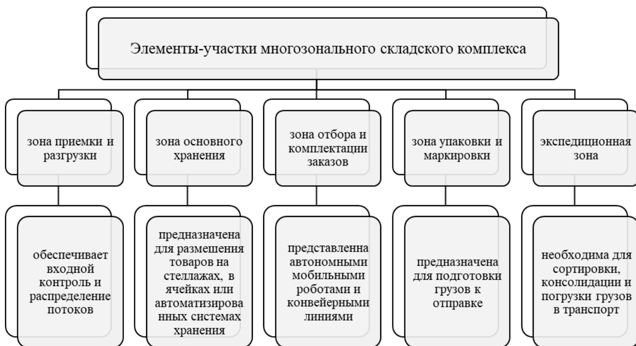
Рис. 2 – Элементы-участки многозонального складского комплекса, составлено автором
