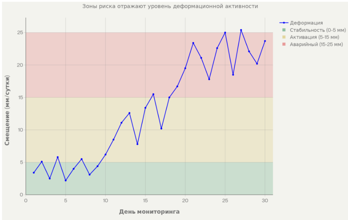
Рисунок 1. Динамика деформаций (мм/сутки) по GNSS-мониторингу.
