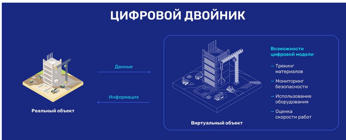
Рисунок 1. Взаимодействие реального и виртуального объектов в концепции цифрового двойника
