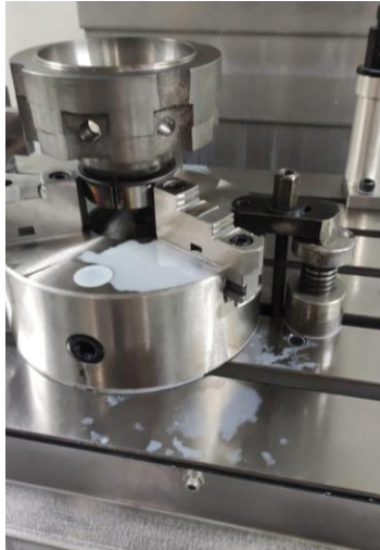
Рис. 6 – Закрепление патрона на столе фрезерного обрабатывающего центра
