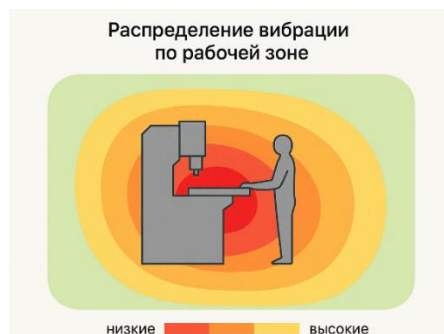
Рисунок 3 - Схема распределения вибрации по рабочей зоне станка.
