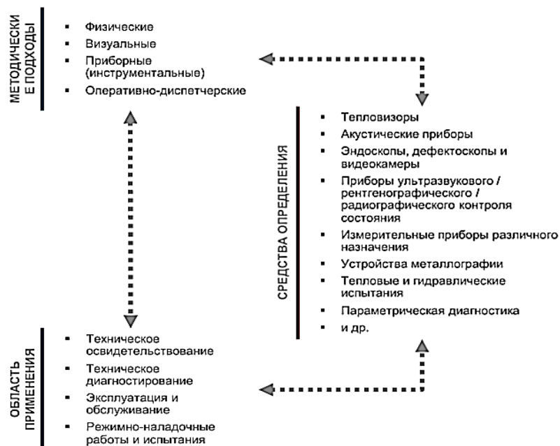
Рисунок 6. Основные средства определения повреждений
