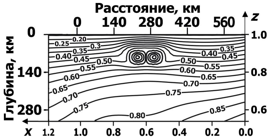
Рисунок 5. Распределение безразмерной температуры (изотермы в интервалом 0.05) и функции тока (вихревые линии тока, показанные с интервалом 4) в момент максимального внедрения теплового диапира с температурой \sim 10^3 K в Евразийскую плиту. Конвективный тепловой поток \sim 10^3 мВт \times м 2 из центра конвективной ячейки в «голове» диапира распределяется по ширине конвективной ячейки и обеспечивает тепловой поток \sim 10^2 мВт \times м 2 на расстоянии \sim 280 км к северо-востоку от зоны субдукции.
