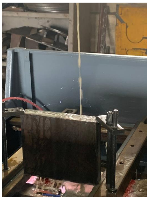
Рисунок 8 – Процесс обработки на электроэрозионном станке
