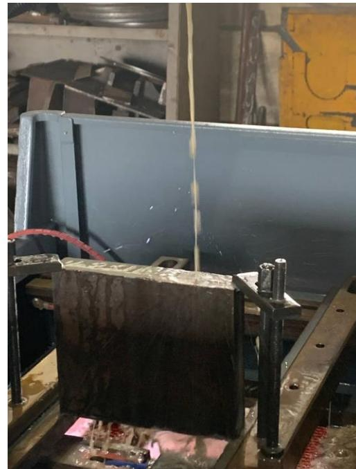
Рисунок 8 – Процесс обработки на электроэррозионном станке
