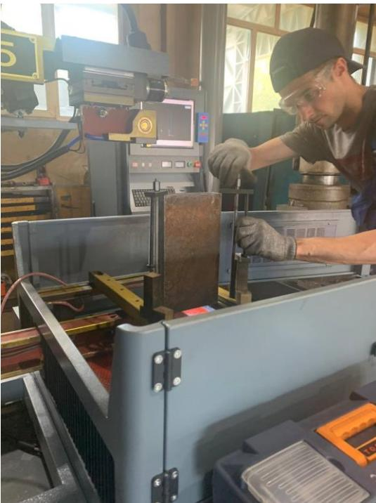
Рисунок 6 – Закрепление заготовки
