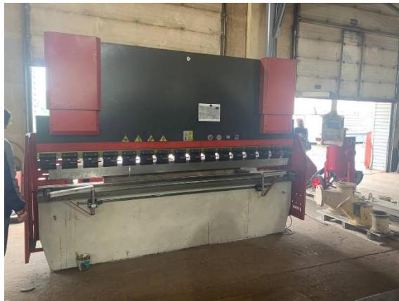
Рисунок 2 - Гидравлический листогибочный пресс с ЧПУ
