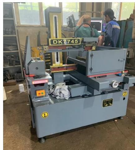
Рисунок 3 - Электроэррозионный однопроходной проволочно-вырезной станок
