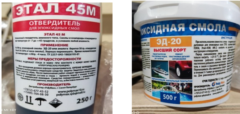
Рис.3 – Состав химического анкера
