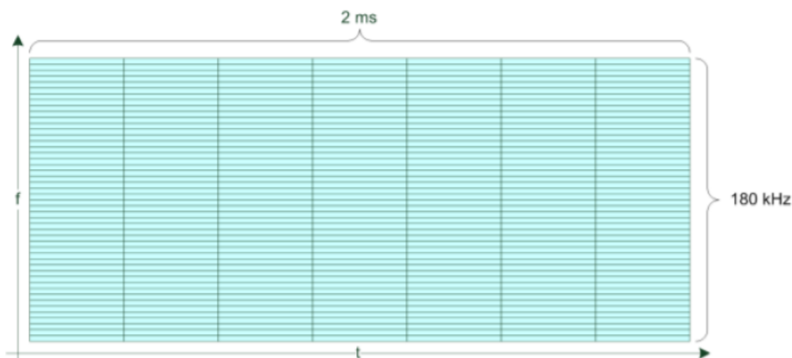
Рисунок 1. Структура слота NB-IoT в восходящем канале (при разносе поднесущих в 3.75 кГц)
