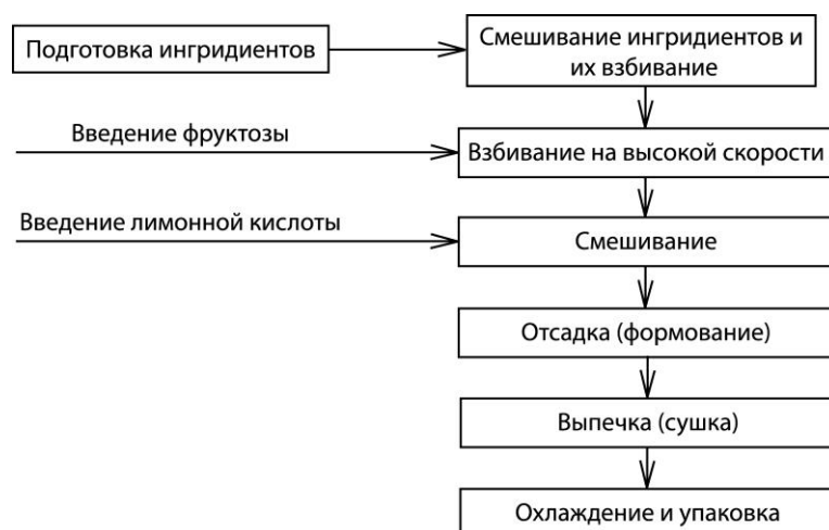
Рисунок 11. Технологическая схема производства безе обогащенного фруктозой
