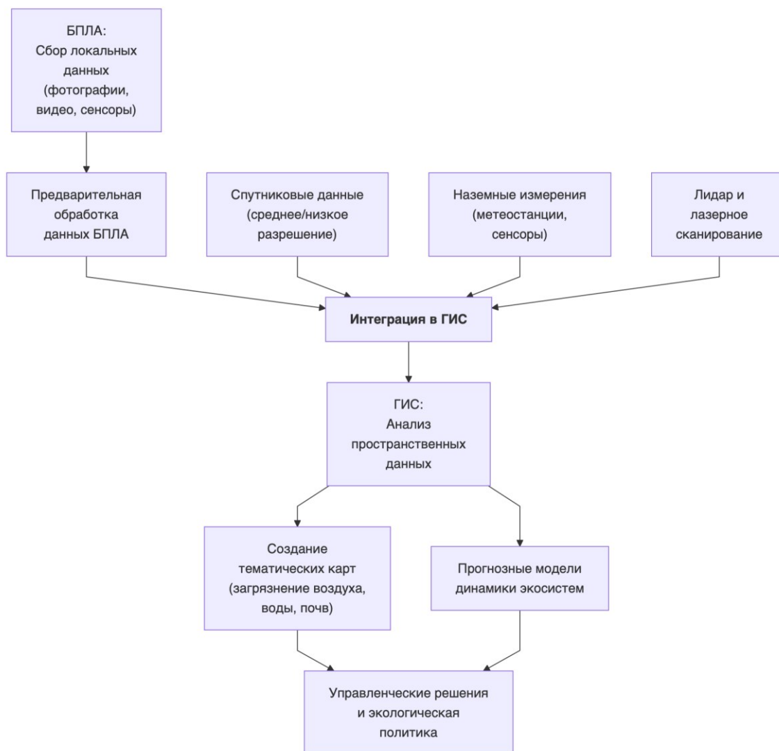
Рисунок 3.3. Интеграция данных БПЛА в систему ГИС
