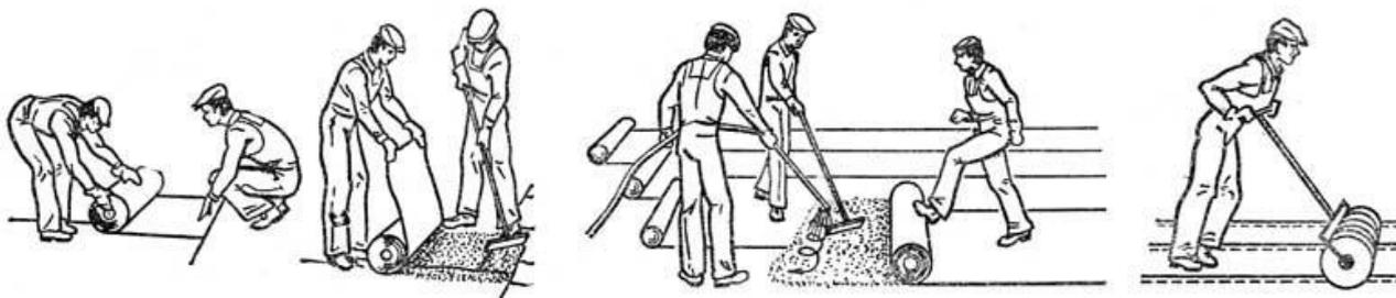
Рис. 17 Устройство рулонной кровли
