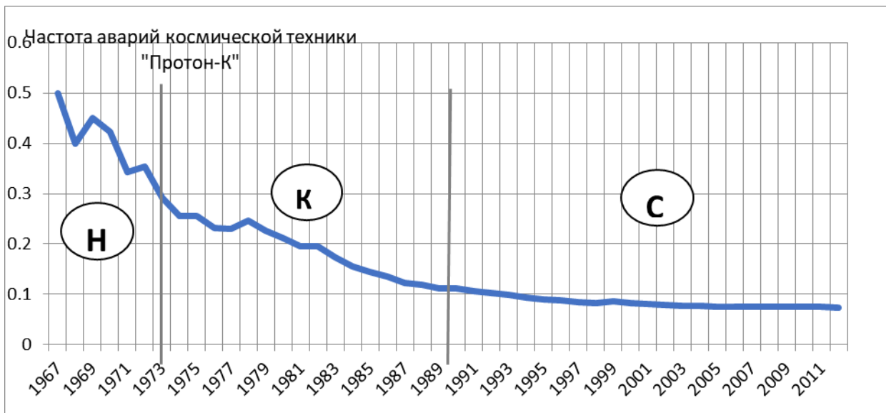
Рисунок 5.2. Аварийность ракеты-носителя Протон-К. Фазы жизненного цикла – Н – начальная, К – критическая, С – фаза стабильности
