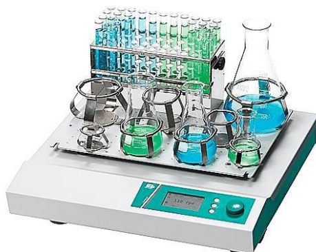
Рисунок 22. Приборы для перемешивания жидкостей (шейкер)
