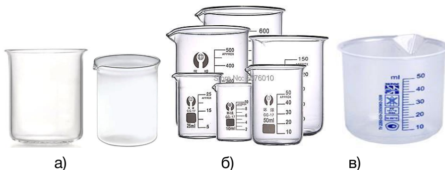
Рисунок 7. Химические стаканы: без градуировки (а), мерные из стекла (б), мерные пластиковые (в)
