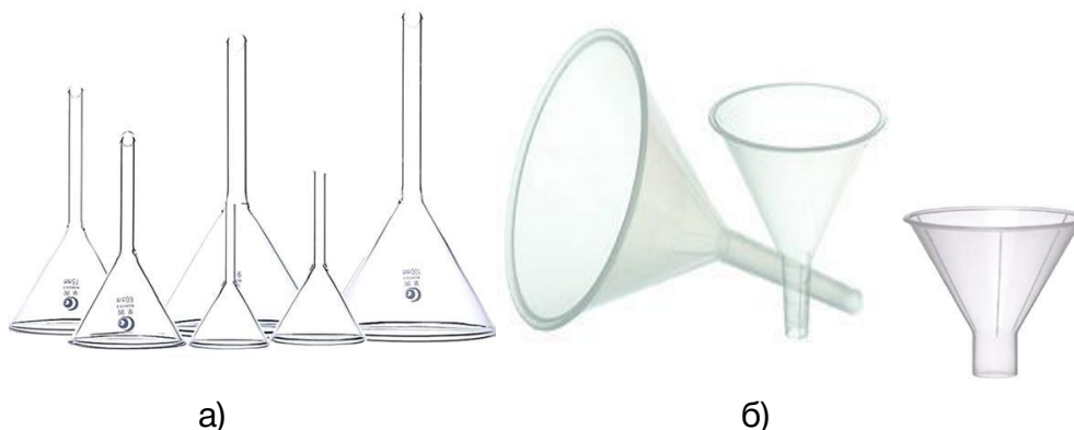
Рисунок 6. Стекланные (а) и пластиковые (б) химические воронки
