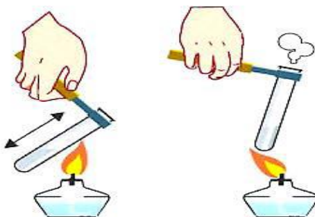
Рисунок 5. Правильное нагревание пробирки
