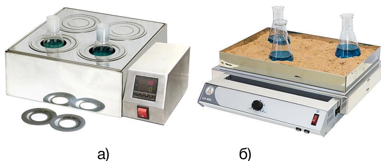
Рисунок 24. Лабораторные бани: водяная (а), песочная (б)
