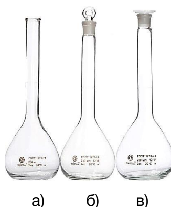
Рисунок 10. Мерных колбы: классическая (а), со шлифованной горловиной и стеклянной пробкой(б), с пластиковой пробкой (в)
