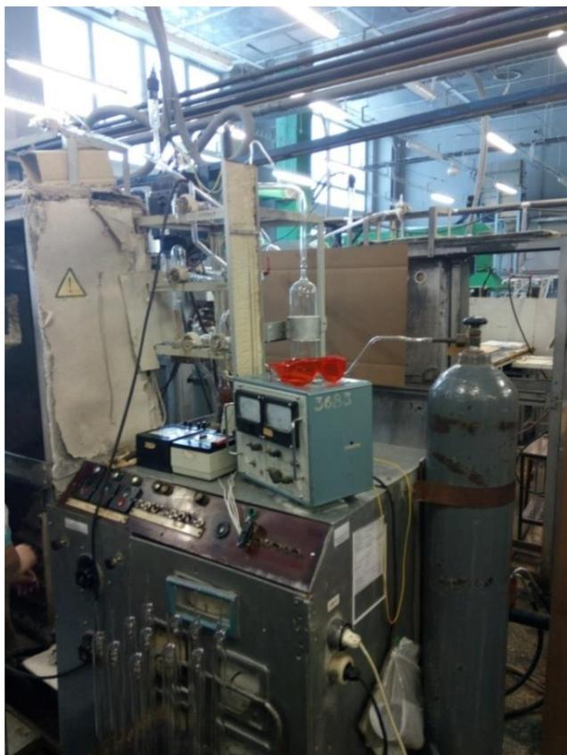
Рисунок 1. Откачной пост для откачки воздуха люминесцентных ламп
