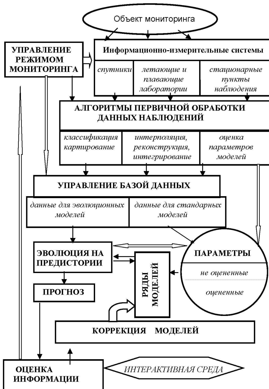
Рисунок 4.1. Концепция адаптивно-эволюционной технологии использования информационно-измерительных систем
