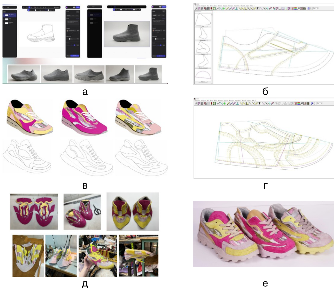
Рисунок 11. а – Эскизы, разработанные в нейросети, б – чертеж модели в САПР АСКО-2D коллекции обуви «Будущее рядом. Любовь к традиции с верой в научный прогресс», в – эскизы, разработанные в Adobe illustrator, б – чертеж модели в САПР АСКО-2D, д – этапы сборки заготовки, е – изготовленные в материале модели обуви коллекции «Дэнксия», автор студ. Казакова С.В. (архив каф. ХМКиТИК)
