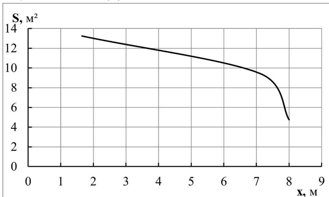
Рисунок 4 – Зависимость площади блокирования сигнала от координаты передающего устройства
