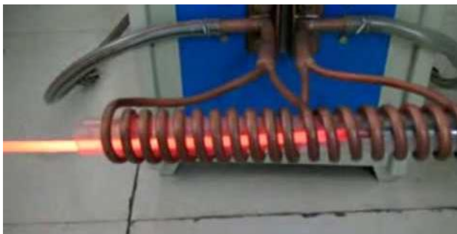
Рис. 9. Нагрев прутка в установке ТВЧ
