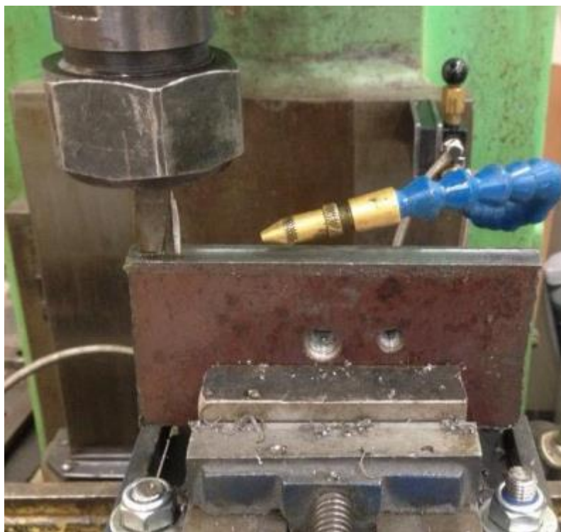
Рисунок 2.7. Способ подачи СОТС в зону обработки резанием
