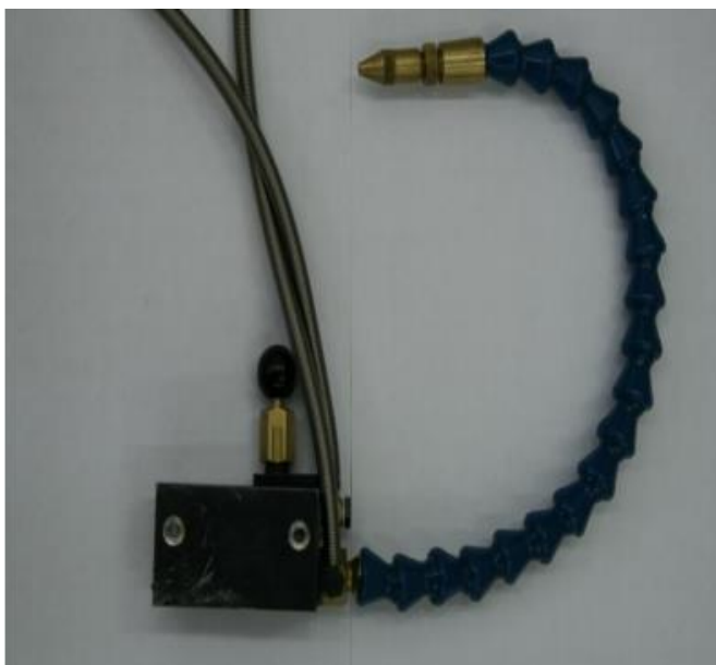
Рисунок 2.8. Специальное устройство для минимальной подачи смазывающего вещества
