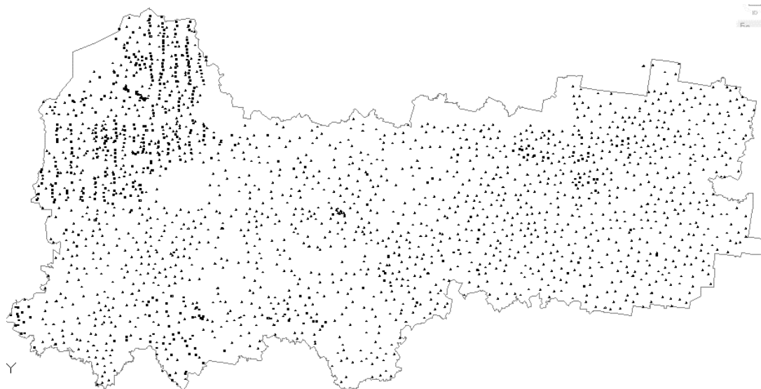
Рисунок 2.2.3. Схема расположения пунктов государственной геодезической сети на территории Вологодской области
