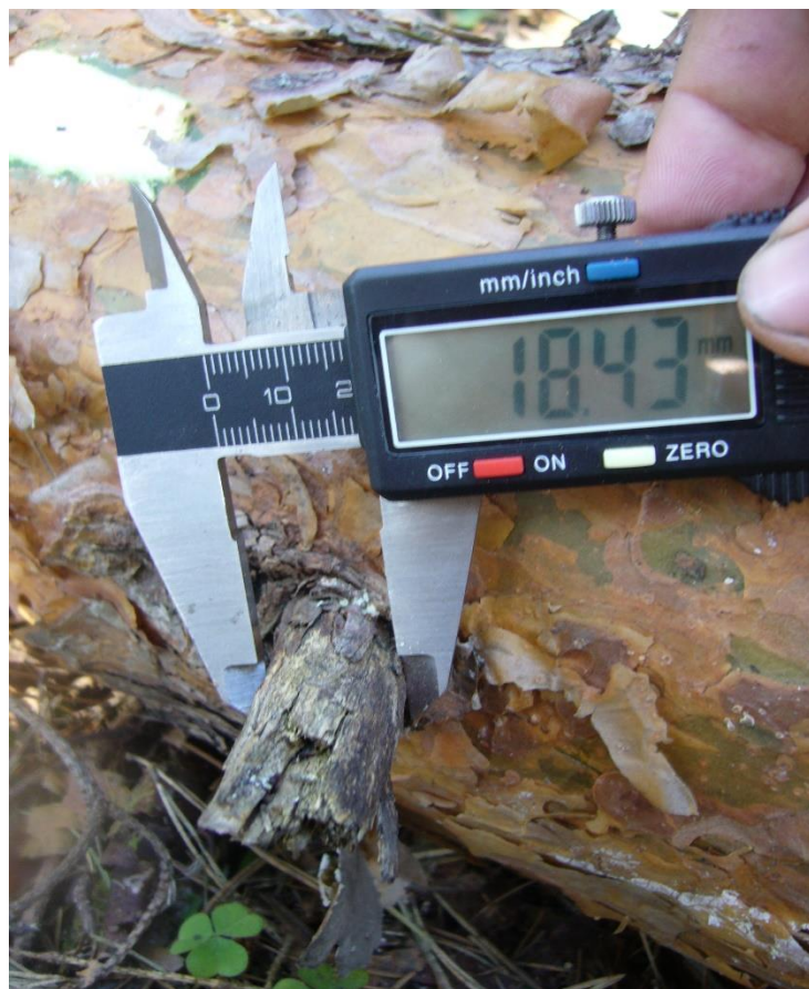
Рисунок 3.3.1. Замер диаметра у основания сучка с помощью электронного штангенциркуля марки ШПЦ - III – 400.
