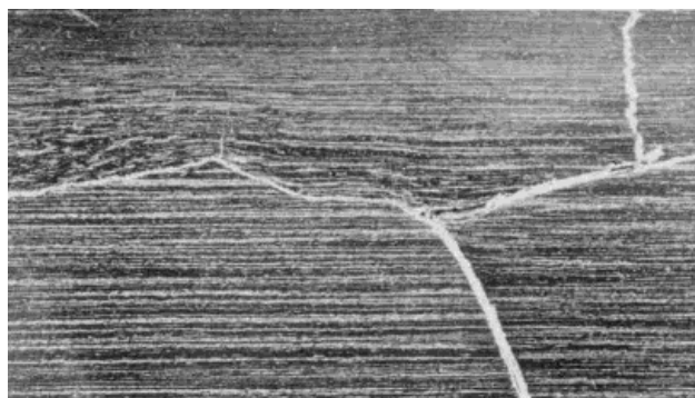
Рисунок 1.2.6. Макроструктура в зоне продольно поперечных трещин усталости в головке рельсов. Эпицентр повторяет дефекты полосчатой структуры (травление первичным реактивом)
