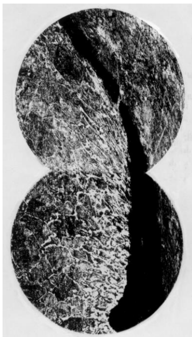
Рисунок 1.2.4. Микроструктура рельса в зоне наплыва на боковую грань
