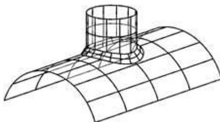
Рисунок 1. Конечно-элементная модель емкости с технологической площадкой и штуцером (фрагмент)
