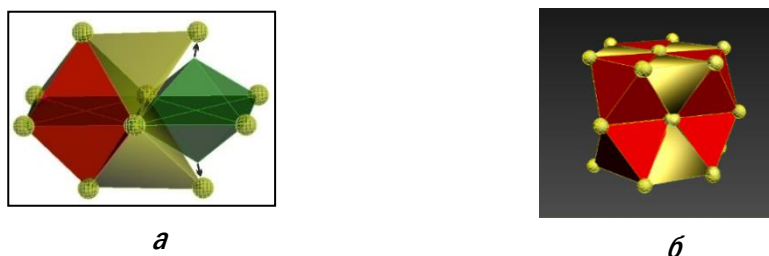
Рисунок 4. Кластерная модель перехода из фазы с ОЦК решеткой через фазу с ГЦК решеткой в фазу с ГПУ решеткой.
