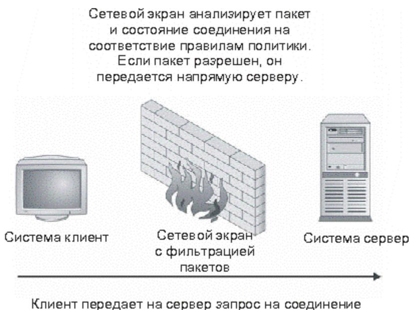
Рисунок 2. Передача трафика через межсетевой экран с фильтрацией пакетов
