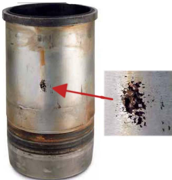
Рисунок 3. Дефект внешней поверхности гильзы цилиндров
