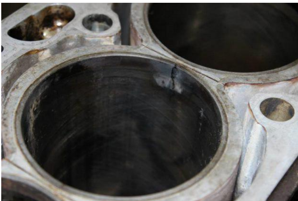
Рисунок 5. Излом бурта гильзы цилиндров
