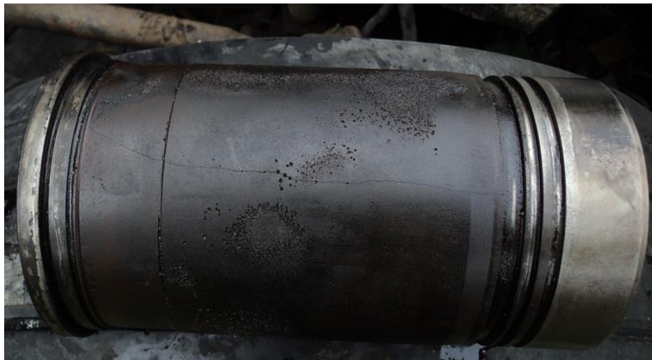
Рисунок 4. Трещины на поверхности гильзы цилиндров
