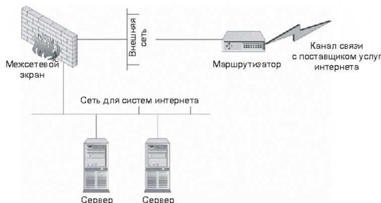
Рисунок 2. Использование архитектуры «Один межсетевой экран»
