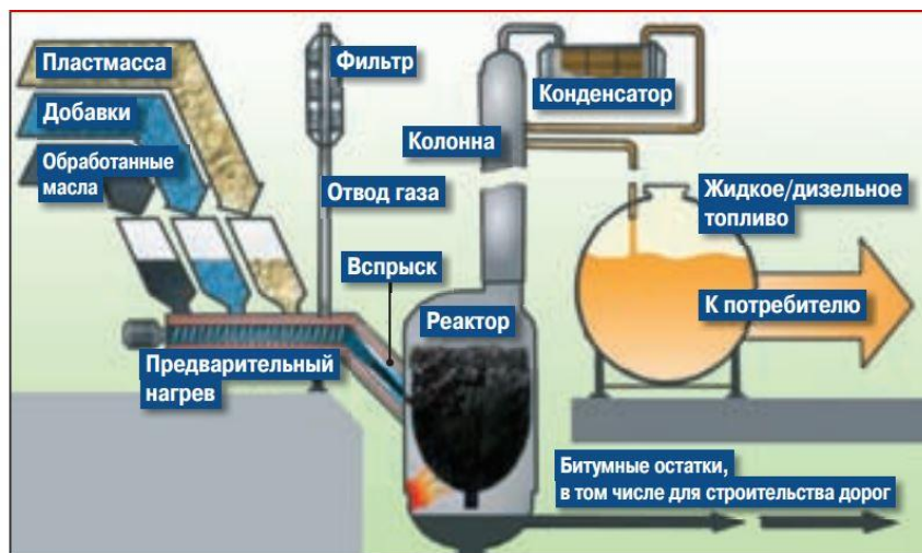
Рисунок 3. Схема процесса изготовления жидкого (дизельного) топлива из отходов полимерных материалов по технологии «Кливия»
