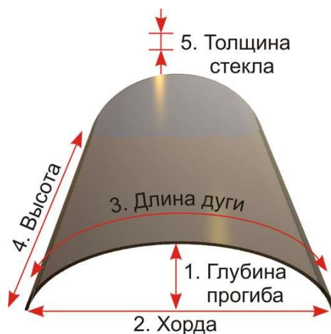
Рисунок 2. Геометрия закаленного гнутого стекла
