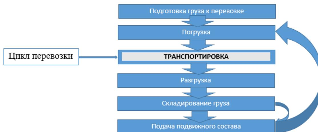
Рисунок 6. Схема технологического процесса перевозки грузов
