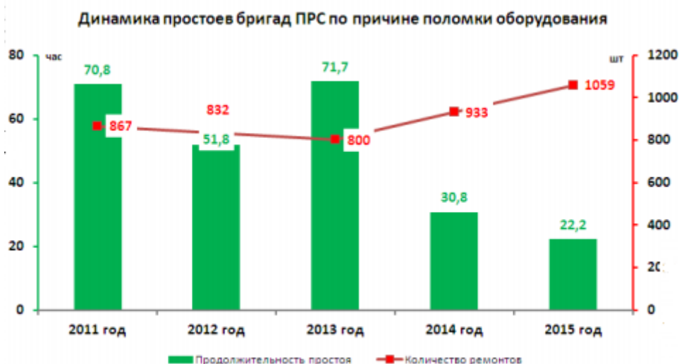
Рисунок 4. Динамика простоев бригад подземно-ремонтных скважин по причине поломки оборудования
