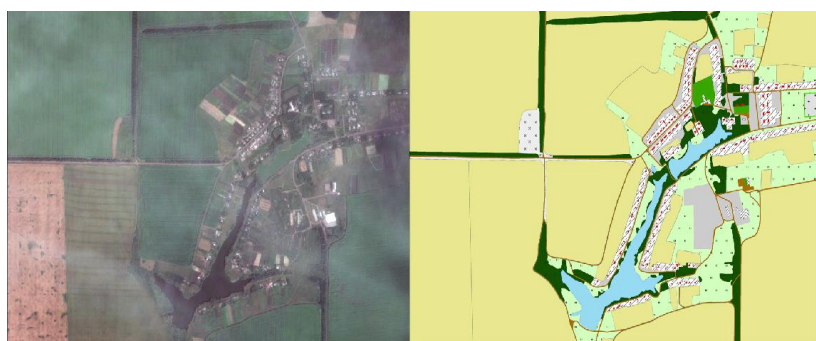
Рис. 2 Картографическая основа по материалам космической съемки сверхвысокого разрешения (Космический снимок Pleiades, пространственное разрешение 0,5 м)
