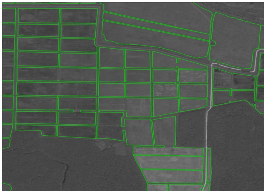
Рис. 1 Результат создания карты границ полей. (Космический снимок ALOS PRISM, пространственное разрешение 2,5 м)
