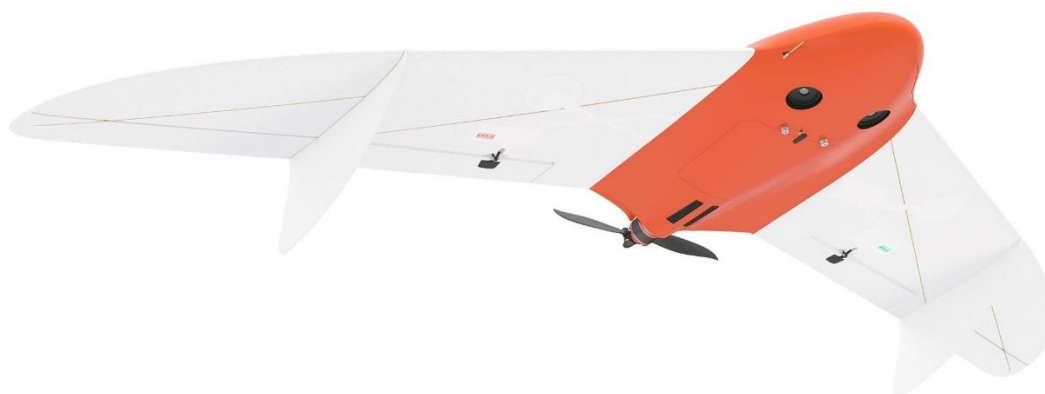
Рисунок 1. Внешний вид БПЛА Геоскан 201 в комплектации «Агрогеодезия»
