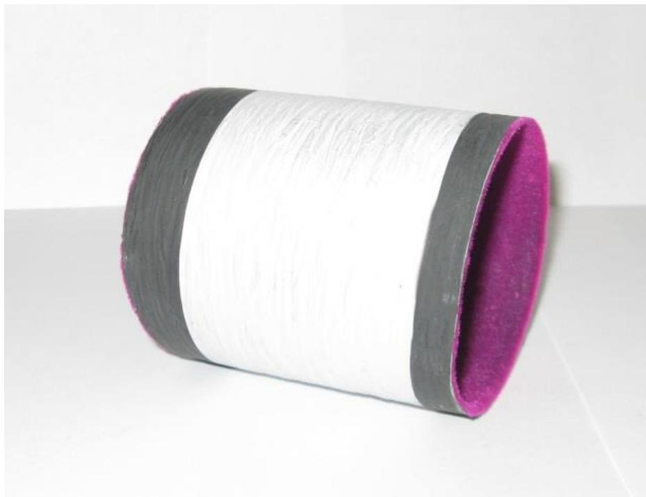
Рисунок 4. Деталь после напыления внутренней цилиндрической поверхности
