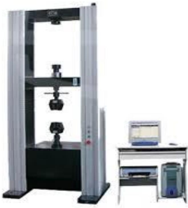
Рисунок 1. Общий вид разрывной машины WDW- 200E
