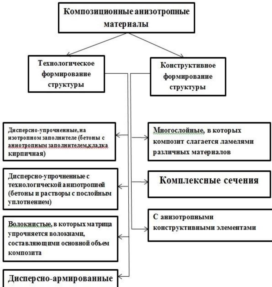
Рисунок 1. Классификация композиционных анизотропных материалов по структуре
