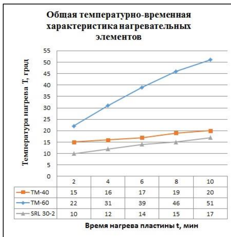
Рисунок 2. Общая температурно-временная характеристика нагревательных элементов
