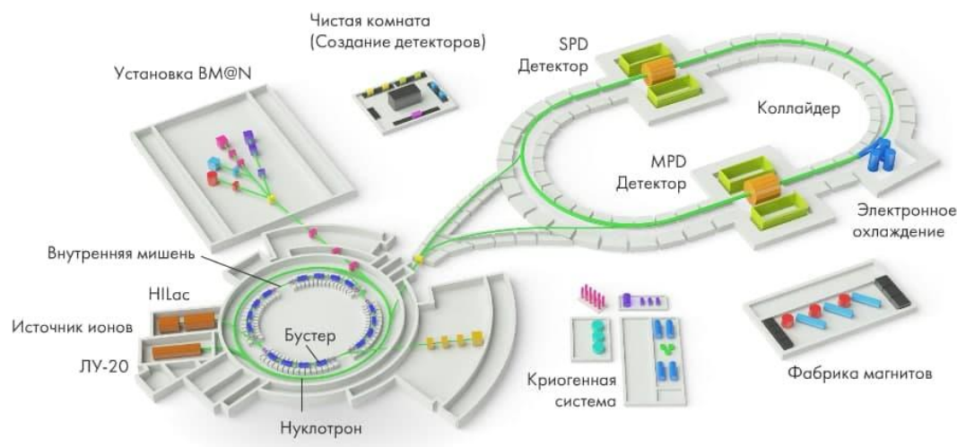
Рисунок 2. Схема ускорительного комплекса NICA
