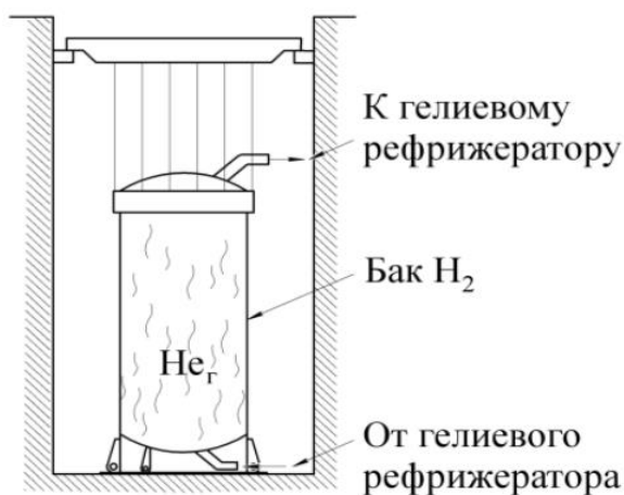
Рисунок 1. Схема охлаждения водородного бака [4]
