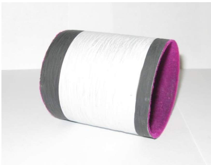
Рисунок 4. Деталь после напыления внутренней цилиндрической поверхности
