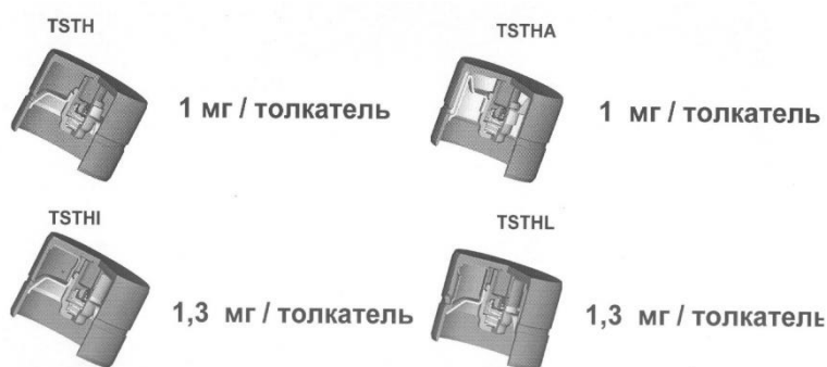
Рисунок 2. Допустимое остаточное загрязнение гидравлических толкателей в соответствии с нормами QN 5.07 A.
