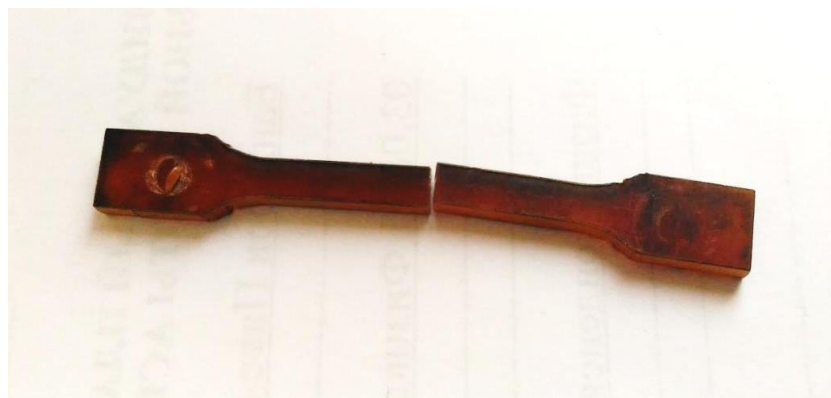
Рисунок 3. Вид образца после испытания
