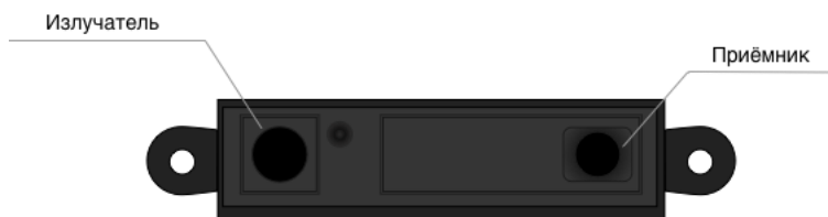
Рисунок 4. Промышленный оптический дальномерный модуль GP2Y0A21YK0F
