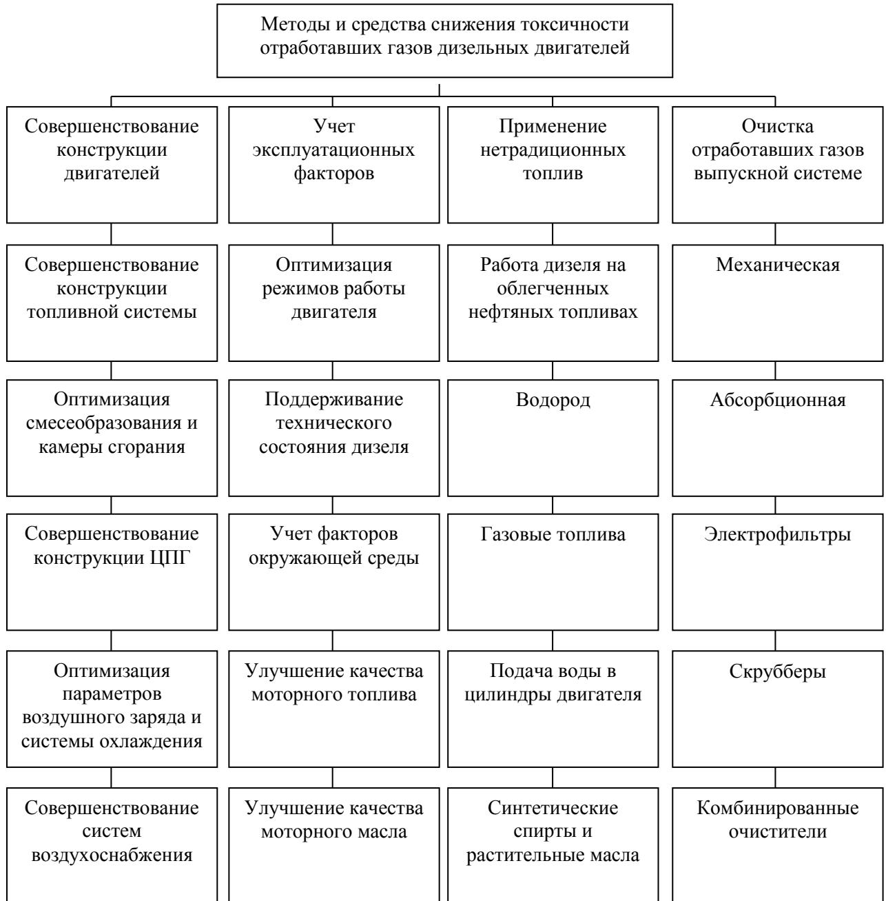
Рисунок 1. Методы и средства снижения токсичности отработавших газов дизельных двигателей
