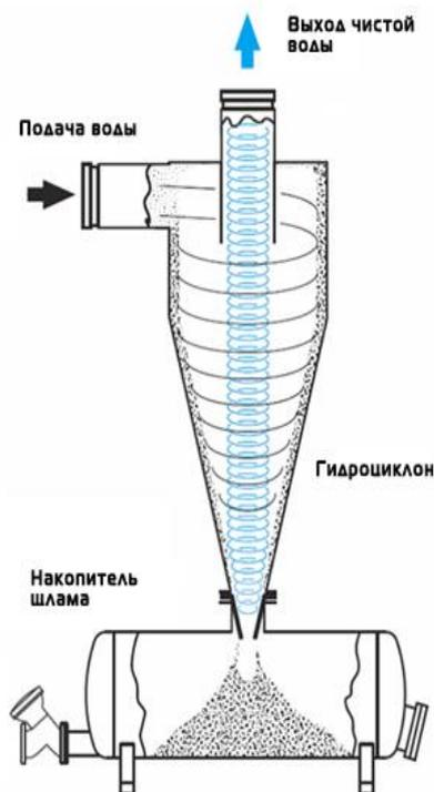
**Рис. 5. Напорный гидроциклон**
