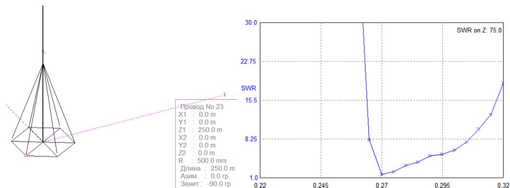
**Рис. 12. Модель заземлённого несимметричного плеча шлейф-вибратора Пистолькорса с раздвинутыми проводниками в основании**
