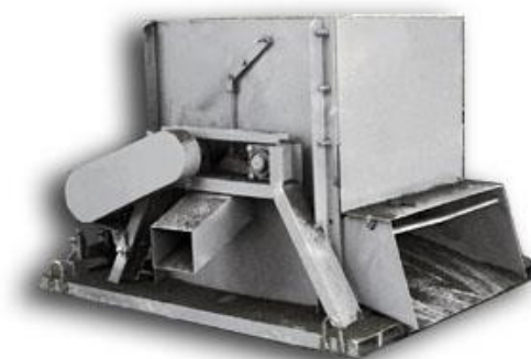
Рис.4. Мобильная установка для переработки рубероида.
