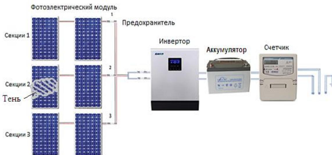
Рисунок 5.7. Схема соединения ФЭМ с частичной затенённостью с его регулирующими устройствами.
