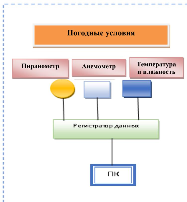
Рисунок 5.1. Комплексная схема измерения климатических факторов.
