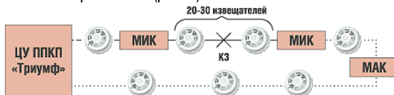
Рис. 4. Схема подключения модулей изоляции короткого замыкания (МИК)
