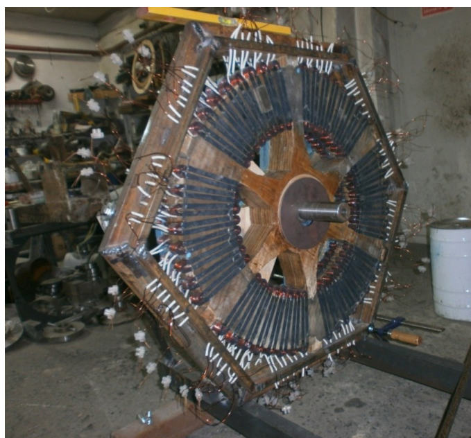
Рисунок 2.1 – Лабораторно-экспериментальная модель электрического генератора
