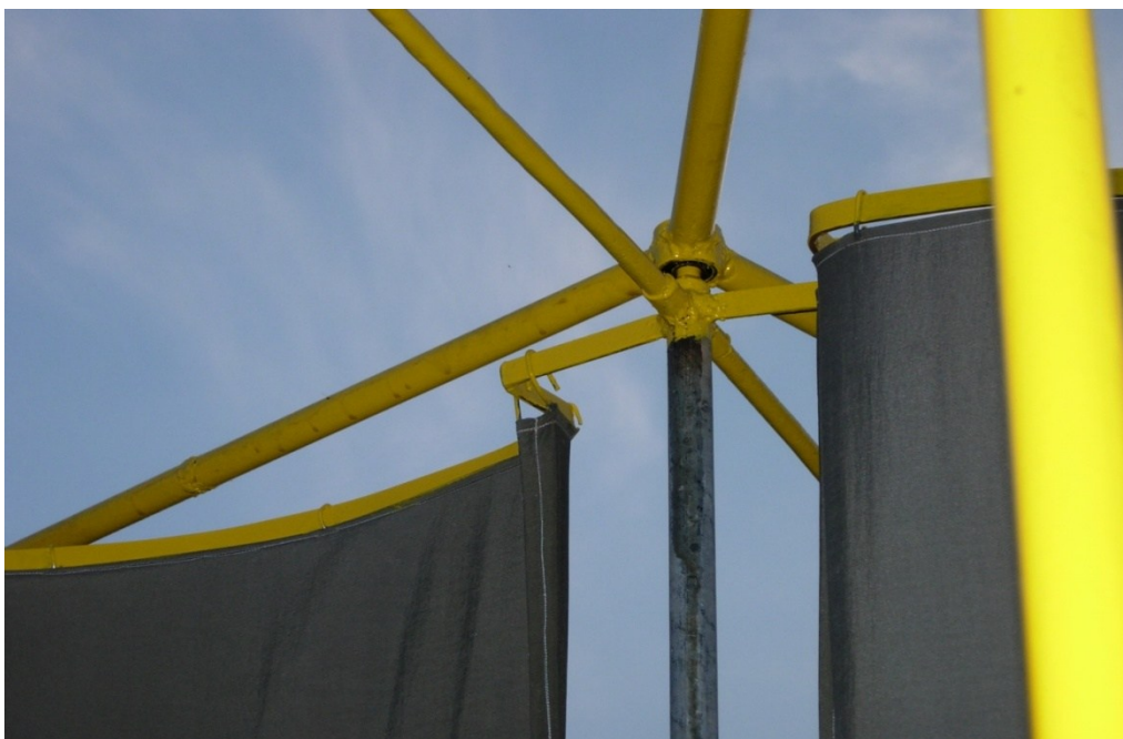
Рисунок 4.5 – Верхняя часть ВЭУ с опорным подшипником
