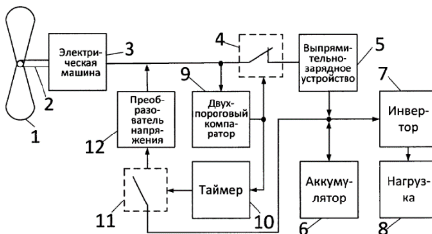
Рисунок 1.42 – Схема ветрогенератора, где вместо измерителя скорости вращения ротора ветрогенератора используется двухпороговый компаратор
