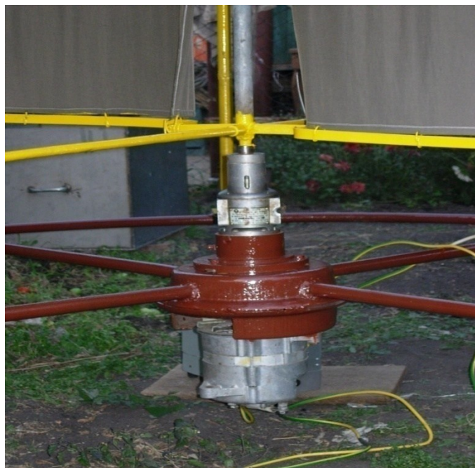
Рисунок 4.4 – Основание ВЭУ с редуктором и генератором
