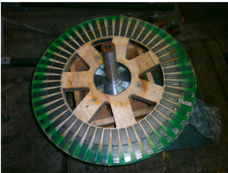
Рисунок 2.2 – Лабораторно-экспериментальная модель электрического генератора (ротор)
