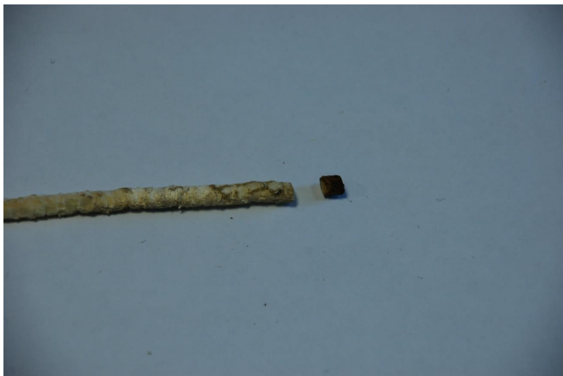
Рис. Б.14. Керн пригодный для исследований (отвалилась только кора)
