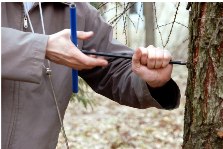
Рис. Б.3. Вворачивание бурава в ствол дерева
