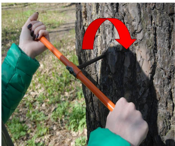
Рис. Б.4. Вворачивание бурава в ствол дерева двумя руками
