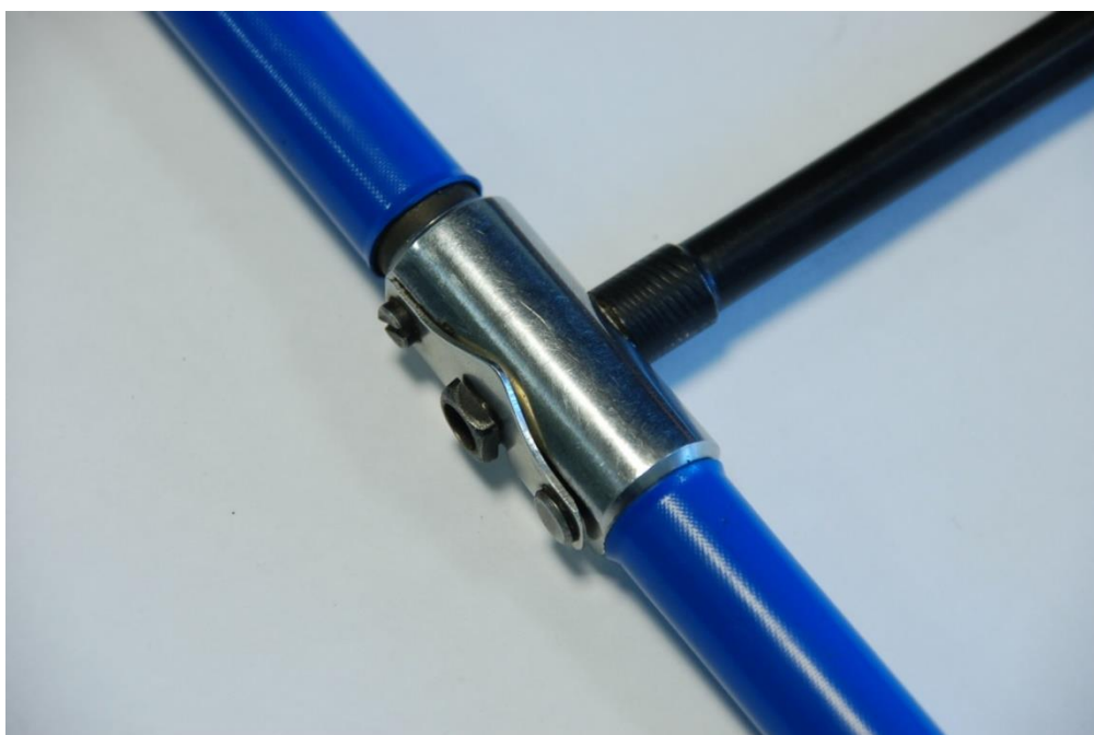
Рис. Б.2. Сборка бурава: закрытие фиксатора
