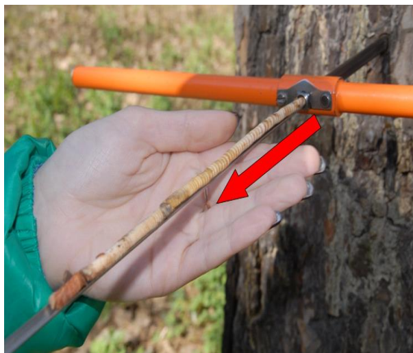
Рис. Б.9. Извлечение экстрактора с керном
