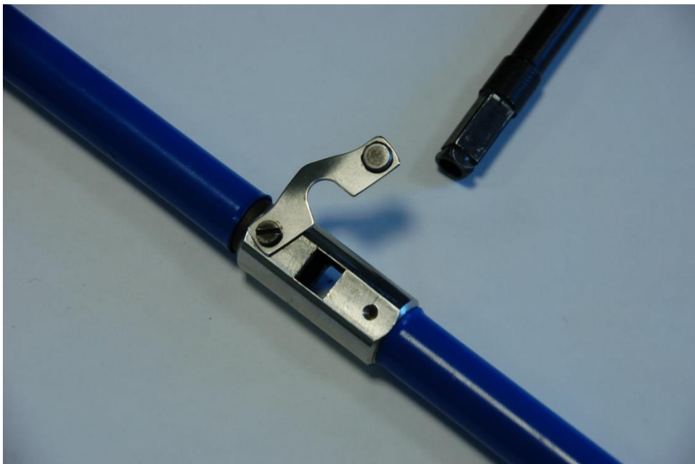
Рис. Б.1. Сборка бурава: открытие фиксатора
