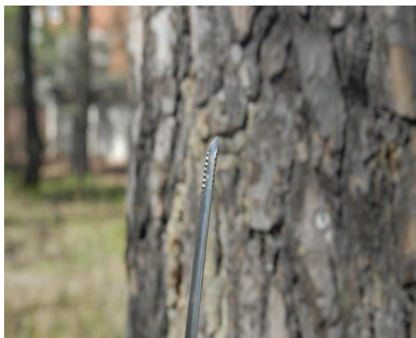
Рис. Б.7. «Зубчики» на конце экстрактора
