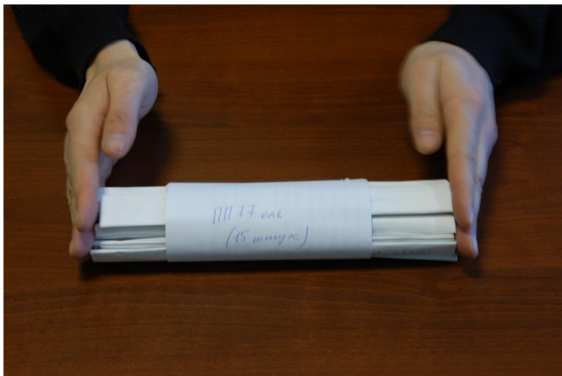
Рис. Г. 12. На футляре подписывается номер пробной площади, порода учетных деревьев и количество кернов
