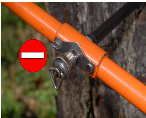
Рис. Б.6. Полностью введенный экстрактор в бурав
